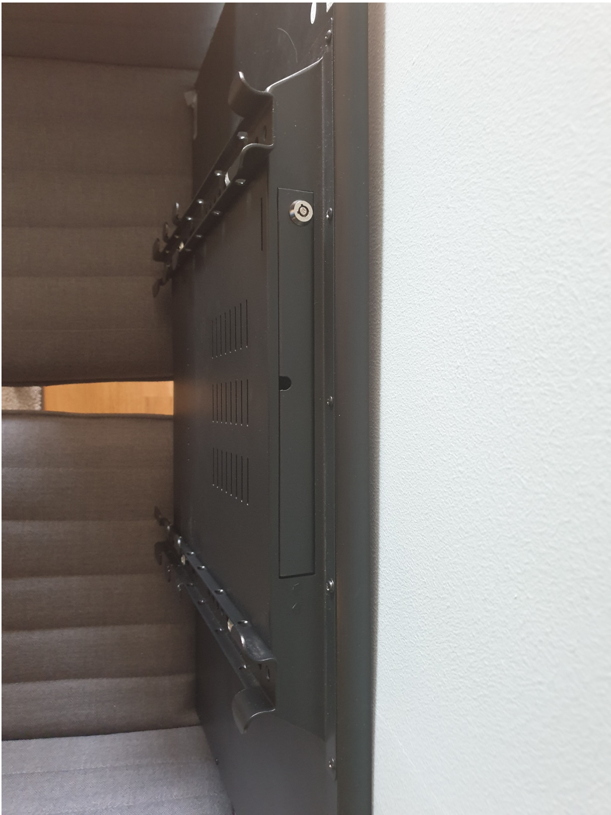
Undersida med lucka som har lås
