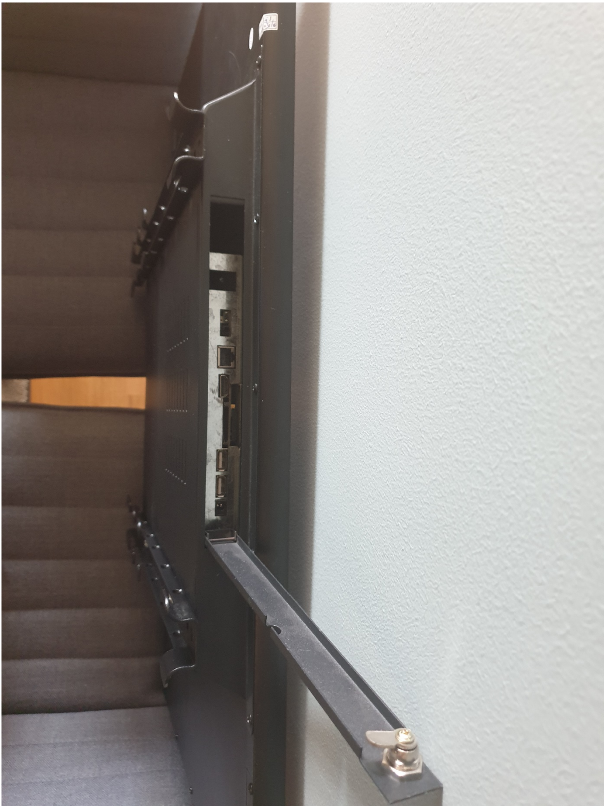
Innanför lucka med lås finns anslutningar för USB, 4G Sim-kort, Nätverkskabel
