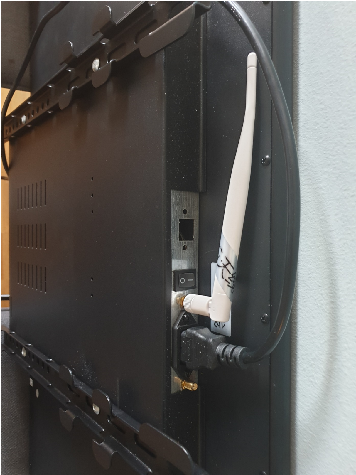
Ovan sida med strömbrytare, eluttag, antenn för WiFi och 4G
